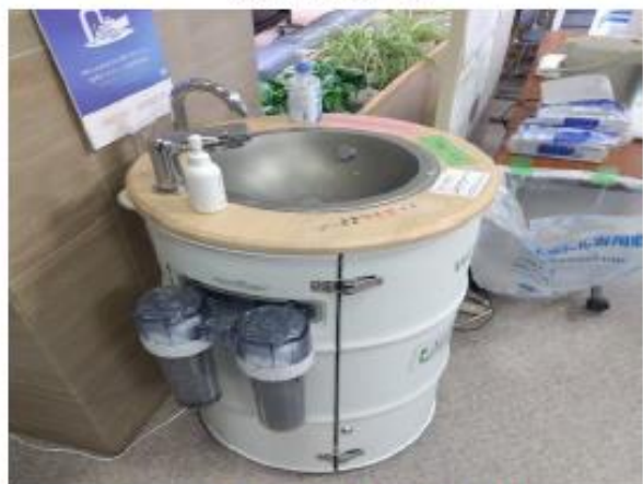
水循環型手洗いスタンド（志賀町）
